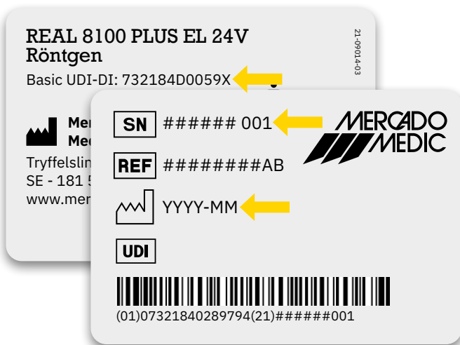
Figur 6.1. Serienummer, UDI-DI och tillverkningsdatum på etikett.
