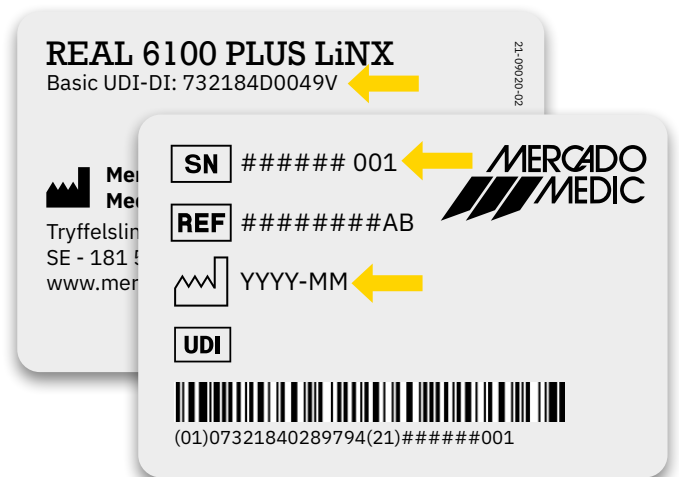
Abb. 6.1. Etiketten mit Seriennummer, UDI-DI und Herstellungsdatum.
