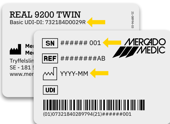
Figur 6.1. Serienummer, UDI-DI och tillverkningsdatum på etikett.
