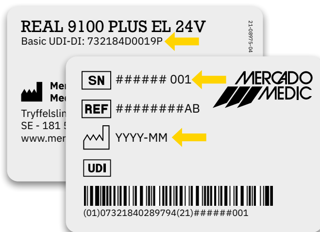
Kuva 6.1. Etikettissä näkyvä sarjanumero, UDI-DI-tunniste ja valmistuspäivämäärä.
