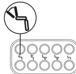
Abb. 5.25. Tasten zur Einstellung der Rückenlehnenneigung.
