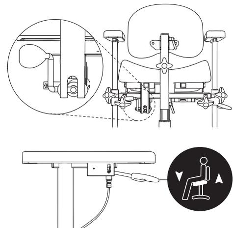
Abb. 5.31. Gasfedersteuerung zur Einstellung des Sitzwinkels.
