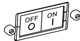
Abb. 5.3. Automatiksicherung.
