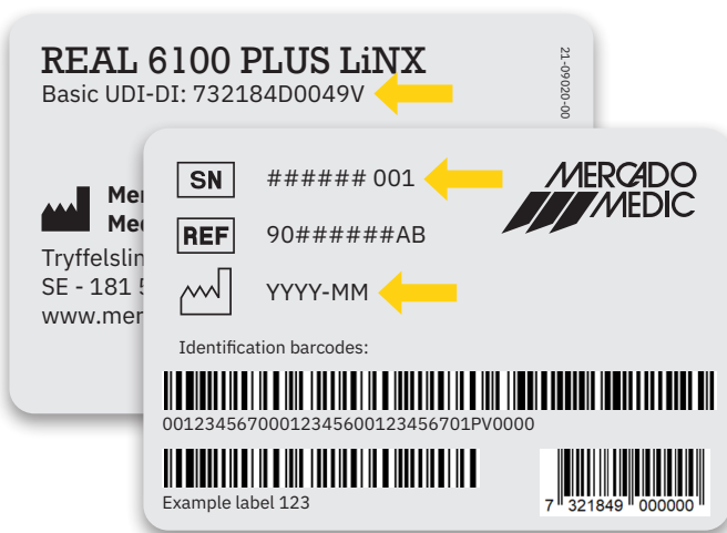
Figuur 6.1. Serienummer, UDI-DI en fabricagedatum op label.
