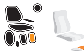
Figuur 5.22. Symbool voor het aanpassen van de lengte van beensteunen met lengtecompensatie.
