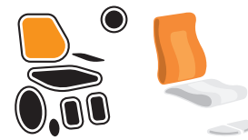
Figuur 5.19. Symbolen voor elektrisch rugkantelmechanisme.
