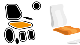
Figur 5.17. Symboler för elektrisk höjdjustering.
