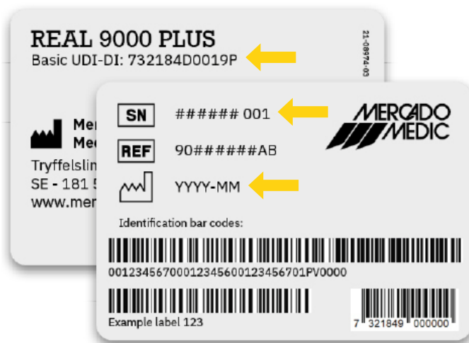
Figuur 6.1. Serienummer, UDI-DI en fabricagedatum op label.
