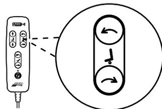
Figura 5.7. Pulsante per la regolazione dell'inclinazione del sedile.
