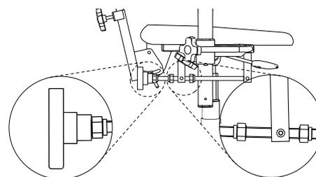
Figura 5.16. Manovella per la regolazione dell'inclinazione del sedile.
