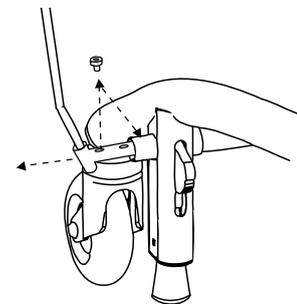
Figura 5.48. Impostazione della staffa della leva del freno.
