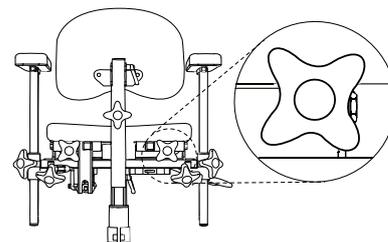
Figura 5.18. Manopole sotto il bordo posteriore del sedile per la regolazione del meccanismo per coxite.
