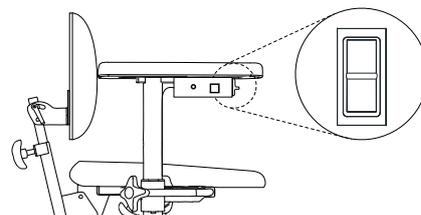
Figura 5.1. Pulsante di regolazione dell'altezza del sedile.
