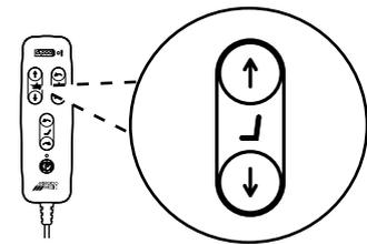
Figura 5.5. Pulsante di regolazione dell'altezza del sedile.
