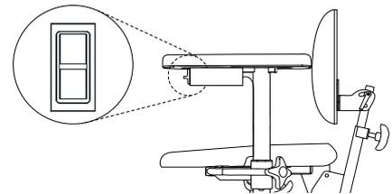
Figura 5.3. Pulsante di regolazione dell'inclinazione del sedile.
