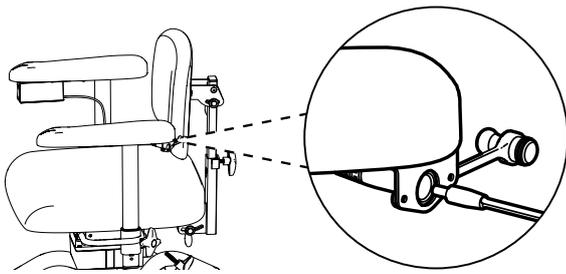
Figura 2.5. Collegamento della spina alla presa di ricarica sotto il bracciolo.
