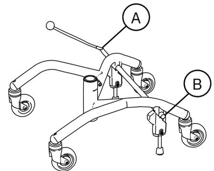
Figura 5.47. Leva del freno.
