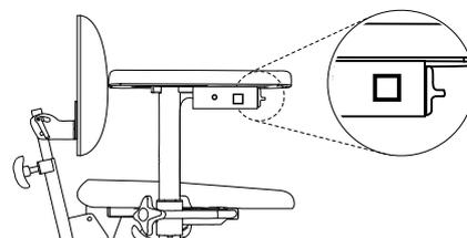
Figura 5.2. Pulsante di inserimento e disinserimento del freno.
