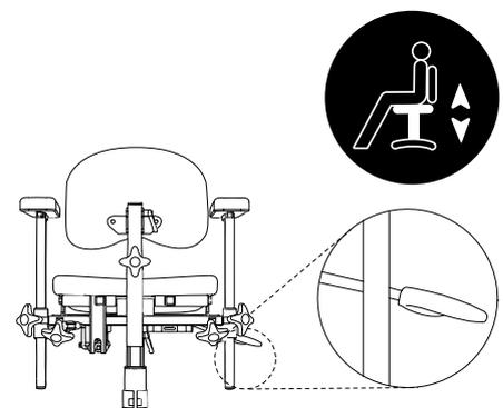
Figura 5.14. Regolazione dell'altezza con molla a gas.
