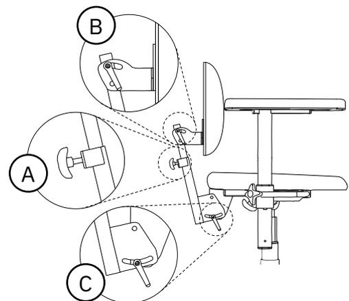
Figura 5.26. Meccanismo dello schienale standard.
