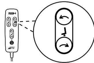
Figure 5.7. Bouton pour ajuster la hauteur d'assise.
