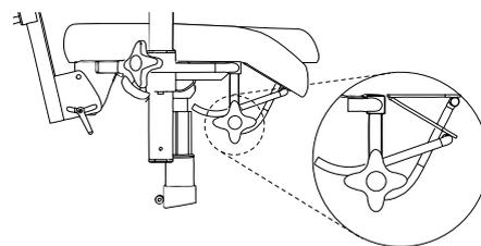
Figure 5.17. Réglage sous le bord avant de l'assise permettant d'ajuster le mécanisme Coxit.
