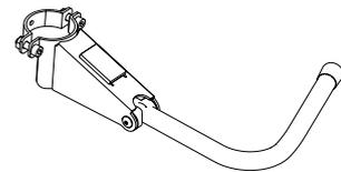
Figure 5.42. Repose-pieds 1/8 modèle gauche.
