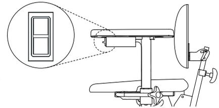
Figure 5.3. Bouton de commande pour ajuster l'inclinaison d'assise.
