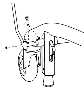
Figure 5.48. Réglage du support de levier de frein.
