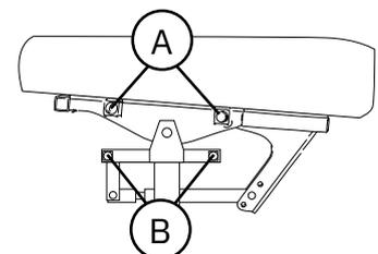
Figure 5.37. Positionnement de l'accoudoir en cas d'utilisation de l'inclinaison de l'assise.
