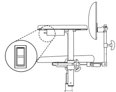
Abb. 5.4. Schalter zur Einstellung der Rückenlehnenneigung.
