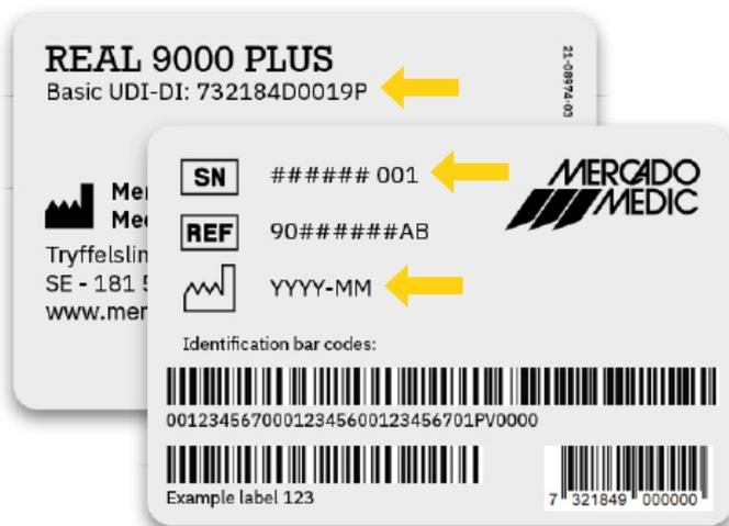
Abb. 6.1. Etiketten mit Seriennummer, UDI-DI und Herstellungsdatum.
