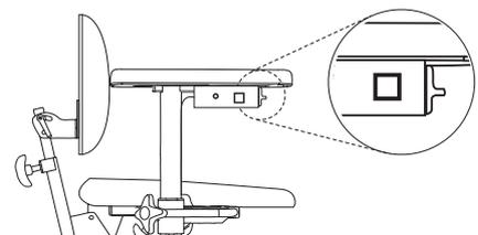
Abb. 5.2. Schalter zum Aktivieren und Deaktivieren der Bremse.
