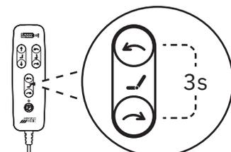
Abb. 5.9. Beispiel: Aktivierung/Deaktivierung der Tastensperre für die Rückenlehnenfunktion.
