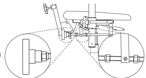
Abb. 5.16. Drehspindel zur Einstellung des Sitzwinkels.
