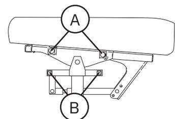
Abb. 5.37. Montage der Armlehnen bei Verwendung der Sitzwinkelfunktion.
